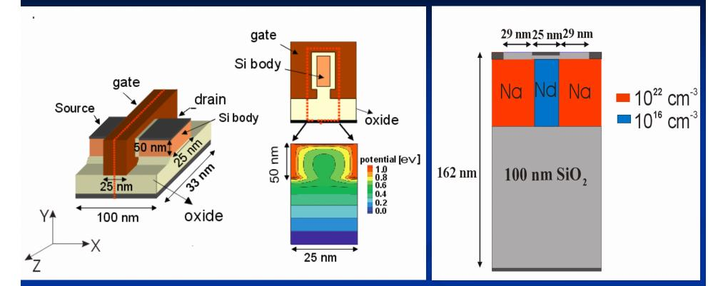
≻H<sub>si</sub> =50 nm , W<sub>si</sub> =25 nm , L<sub>g</sub>=25 nm, doping
